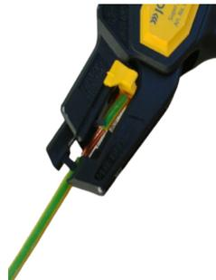
Pince à dénuder **Jokari** permet un dénudage rapide et précis, même dans les endroits difficiles d'accès, aucun ajustement de la section du câble nécessaire, un système de balayage automatique et donc aucun dommage les conducteurs butées de longueur réglable de 6,0 à 15,0 mm pour un dénudage en série régulier · Pince coupante latérale intégrée pour conducteurs jusqu'à 2,5 mm<sup>2</sup>
