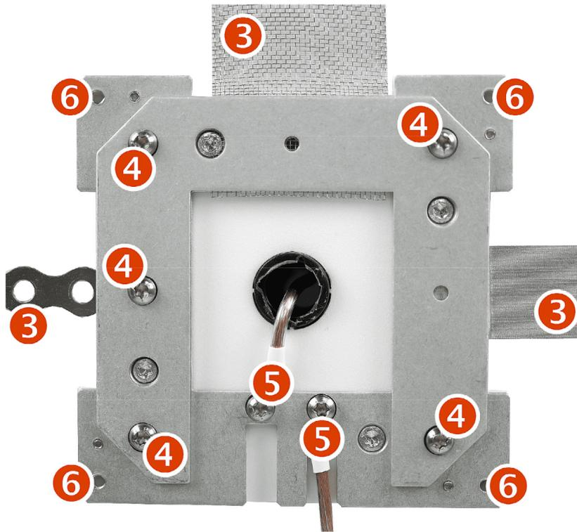
**4** | Appliquez la plaque en forme de U (ouverture vers le bas) et fixez ainsi la bande autocollante de mise à la terre fournie (3) et autres éléments de mise à la terre éventuels à fixer avec les vis M4x6 et les rondelles de blocage fournies (!).
