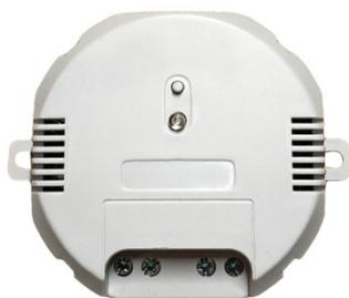
Module sans fil ON/OFF 2500W télécommandé chauffage/éclairage. Permet la mise hors tension à distance des lampes et circuits électriques par télécommande à impulsions. Ce module est un simple récepteur qui permet la coupure de circuits dont la puissance est inférieure à 2500W. La mise hors-tension permet de supprimer les champs électriques des circuits concernés. Protection interne fusible 10A.
