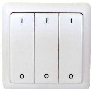
Interrupteur sans-fil pour 1 à 3 circuits par modules télécommandables. Permet la mise hors tension à distance des lampes et circuits électriques divers. Il permet de commander un ou plusieurs modules. Sa portée maximale avec obstacle est de 50 mètres. Il n'émet aucun rayonnement au repos. Alimentation par pile fournie. Fréquence du signal radio : 433,92 MHz. Accessoires de fixations fournis.
