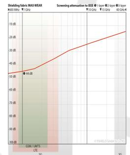
Le tissu **Swiss Shield MAX-WEAR** est un **tissu de blindage hautes fréquences (HF)** en coton semi-transparent. Il est spécialement conçu pour la confection de **vêtement anti ondes**, et contient 3 fois plus de fils d'argent que son prédécesseur Wear. Performances accrues d'atténuation des hautes fréquences de **-44 dB**. 70% coton, 28.5% cuivre, 1,5% argent. Largeur 1,5 m
