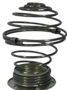
La **spire métallique de blindage E14** permet de **réduire les champs électriques émis par l'ampoule allumée**. Elle convient aux ampoules à incandescence et aux ampoules LED de forme standard avec une douille E14. Pour assurer la mise à la terre, cette spire de blindage doit être utilisée avec une **douille métallique reliée à la terre**.
