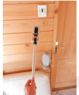
Détecteur d'ondes électromagnétiques **ME3030B Gigahertz Solutions basses fréquences**, entre 16 Hz et 2 kHz, avec perchette isolante pour mesures hors potentiel. Mesure du champ magnétique et du champ électrique. Appareil fiable et très simple d'utilisation.
