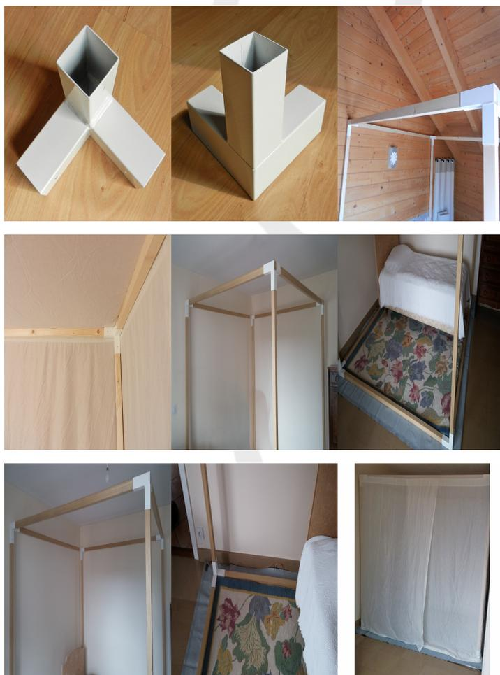
Spécialement conçues pour la réalisation de structures autoportantes sur mesure, ces cornières permettent une installation facile et sans fixations murales de baldaquins. Pour cela 12 tasseaux standards (non fournis) de 45 x 45 mm recoupés à la longueur désirée sont nécessaires - Cornières pré-percées de 15 cm en acier inox thermo laqué blanc - Fabrication française - Guide de construction fourni.
