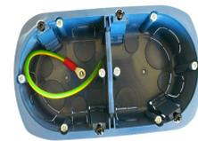
Boîte faradisée double pour pour cloisons sèches 67 X 40 mm. Complète la protection par câbles, fils ou gaines blindés pour les installation en électricité biotique. Assure une réduction locale des champs électriques basses fréquences. Nécessite une mise à la terre. Idéal en éco-construction dans pièces sensibles telles que chambres et lieux de repos et pour les cloisons bois ou plâtre.
