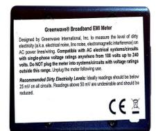
Mesureur d'interférences radiofréquences du réseau électrique "Dirty Electricity" (DE). Le Broadband EMI Meter Greenwave (3kHz-10MHz), est l'équivalent du "DeTekta" ou "Line EMI Meter". A brancher simplement sur une prise de courant, pour valider le pourcentage d'atténuation ou l'intérêt de filtres d'électricité sale. Doté d'une détection sonore permettant d'entendre les pics du CPL Linky.
