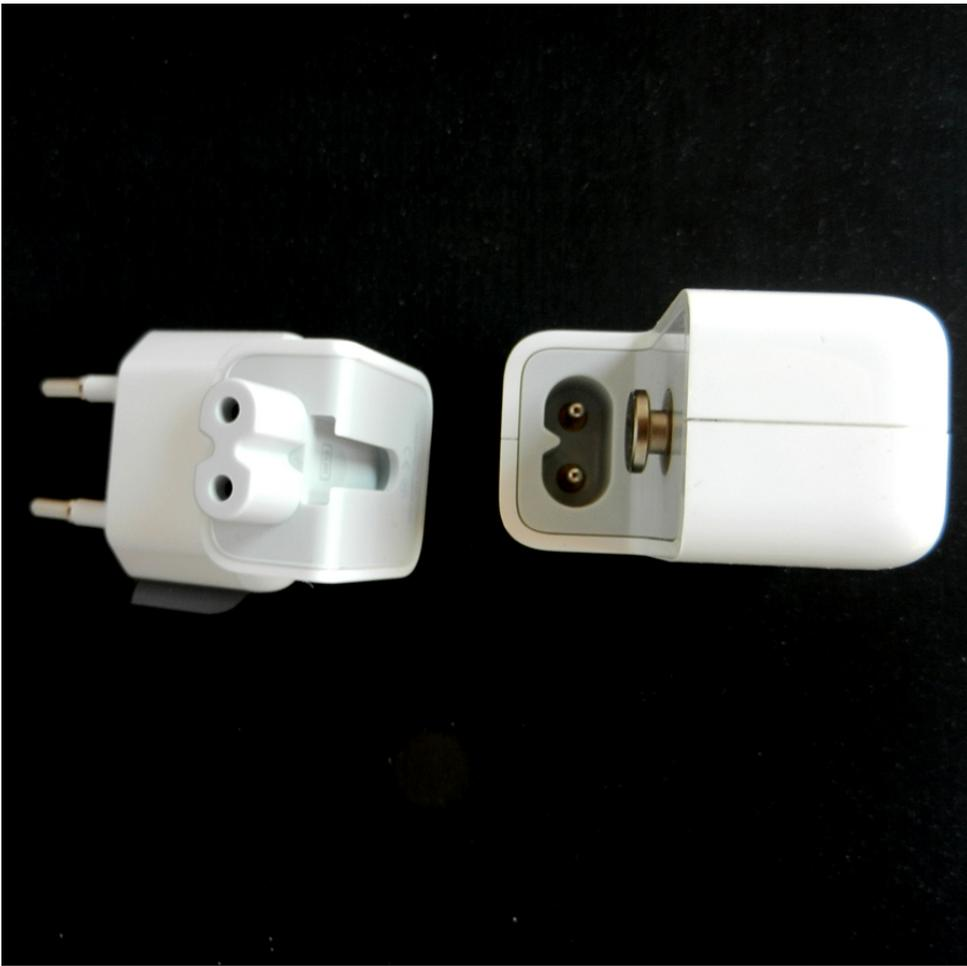
La connectique de terre métallique présente sur la photo ci-dessus sera utilisée avec le câble fourni dans notre kit, adapté au chargeur Apple® d'origine de 10 ou 12W pour iPad. **Attention :** ce câble ne fonctionne pas avec les chargeurs d'iPhone Apple® de 5W, ni sur les nombreuses contrefaçons distribuées sur certains sites bien présents sur le net. Si vous voulez utiliser ce câble sur un iPhone ou iPod, il faudra alors nous commander l'adaptateur secteur Apple® 12W en option ci-dessous (5).
